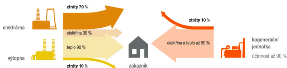
Obrázek 3.1: Porovnání účinností a ztrát při oddělené a kombinované výrobě elektřiny a tepla (ČEZ, a.s.), převzato [10]
